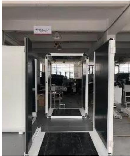
注意事项：1：注意墙板安装之前的缝隙，缝隙 0-0.8mm（可使用舱内工具飞机带）。
